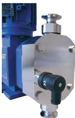
Электрополированная головка насоса с шероховатостью поверхности Ra <0,8 µm с датчиком давления для системы контроля мембраны
